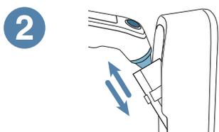
**2 Monter et nyt linsefilter** ved at skubbe probespidsen lige ind i boksen og derefter trække termometeret ud.
