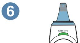
**6 Temperaturmåling.** Et langt bip og konstant grøn ExacTemp-indikator signalerer afslutningen af måleprocessen. Temperaturen vises på displayet.
