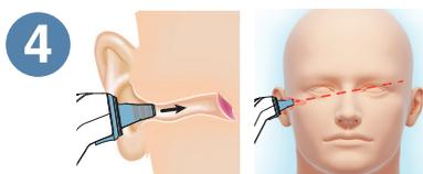
**4 Placer proben, så den sidder tæt i øregangen og direkte imod den modsatte tinding.** Hold termometerproben stille i øregangen. Korrekt placering af proben er vigtig for nøjagtige målinger.
