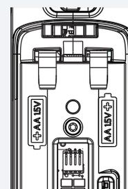
Tag de 2 AA alkaline-batterier ud og erstat dem med 2 nye AA alkaline-batterier og sørg for, at polerne vender rigtigt.
