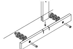
Per favore fate attenzione: per evitare di danneggiare l'asta di misurazione quando la si utilizza, è assolutamente necessario che l'arresto per i calcagni sia puntellato contro la parete! Per questo motivo dovete fissare dietro all'arresto per i calcagni tanti distanziatori, da appoggiare quello posteriore alla parete.
