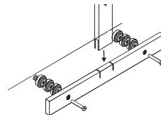
**Bitte beachten Sie:** Um den Messstab bei Benutzung nicht zu beschädigen, muss der Fersenanschlag unbedingt gegen die Wand abgestützt werden! Deshalb müssen Sie hinter dem Fersenanschlag so viele Distanzscheiben befestigen, dass die hintere an der Wand anliegt.
