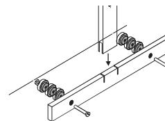
**Huom.:** Jotta mittauslatta ei viitoitu käytössä, kantapäävaste täytyy ehdottomasti asettaa seinää vasten! Tästä syystä kantapäävasteen taakse täytyy kiinnittää niin monta välilevyä, että takimmainen levy tulee kiinni seinään.
