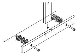
**Let a.u.b. op het volgende:** Om de meetlat bij het gebruik niet te beschadigen moet de hielaaanslag in elk geval tegen de wand worden ondersteund. Daarom moet u achter de hielaaanslag zoveel afstandsschijven bevestigen dat deze achter tegen de wand aanligt.
