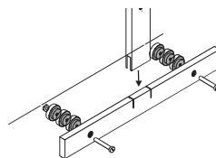
**Bemærk venligst:** For ikke at beskadige målepinden under brugen skal hælanlaget ubetinget støttes mod væggen! Derfor skal De befæstige så mange afstandsskiver bagved hælanlaget, at den bagste skive ligger på mod væggen.
