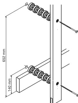
scegliete la distanza dell'asta di misurazione dalla parete. Dovete utilizzare almeno una rondella distanziatrice per ognuno dei punti di fissaggio.
