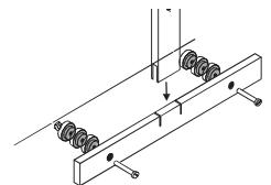
**Nota:** Para não danificar a barra de medição durante a utilização, é imprescindível apoiar o encosto para calcanhares na parede! Por isso é importante colocar anilhas distanciadoras suficientes de modo a que a última anilha fique encostada à parede.
